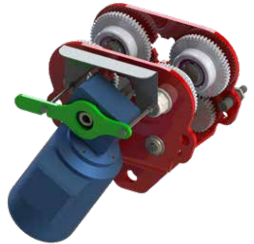
Posisjonsmarkør montert på løpekatt
