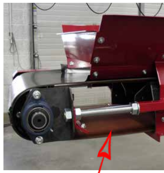
Figur 16: Gjengestenger på strammeenheten. Stram ved å skru til mutterne på begge sider
