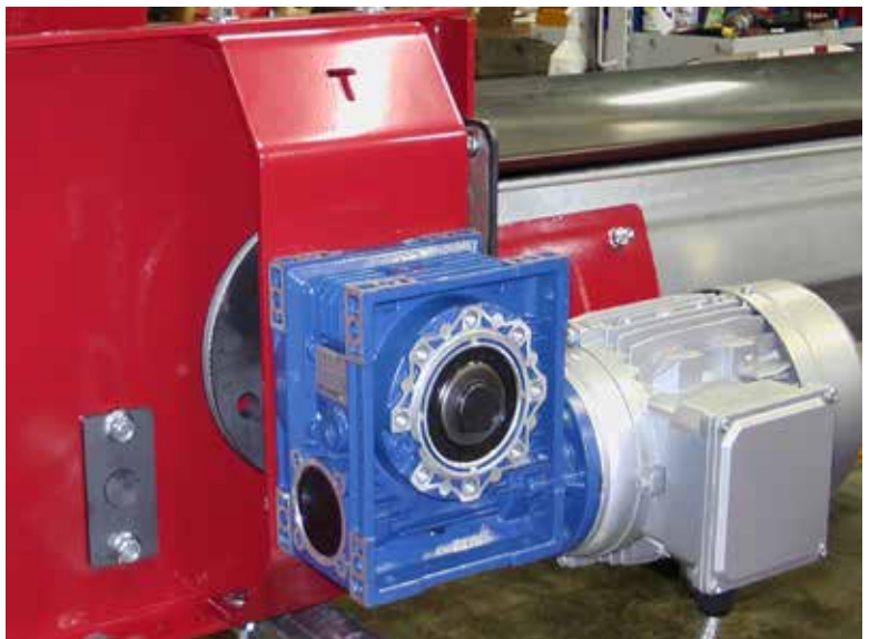
Figur 7: Motor for wiretrekk montert på drivenheten
