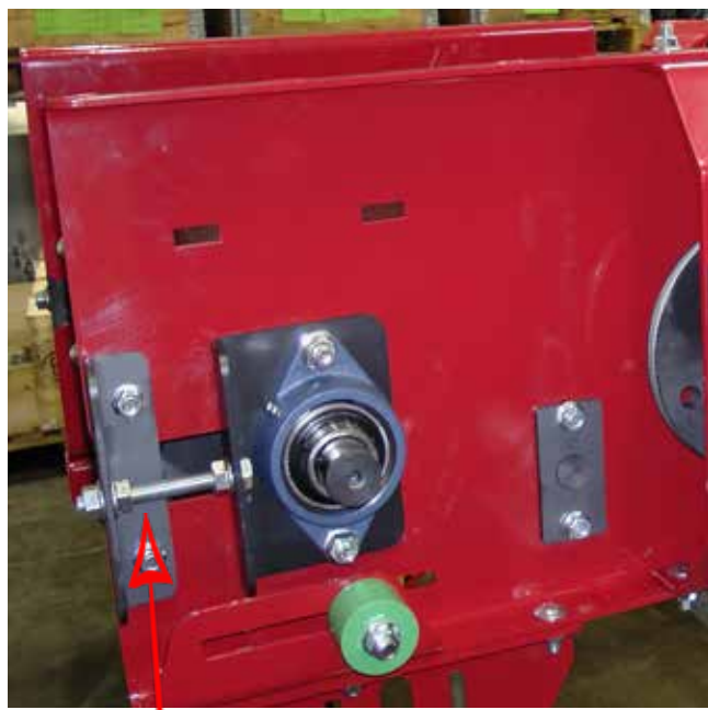
Figur 17: Strammebolter på drivenheten brukes til å justere sporingen av beltet
