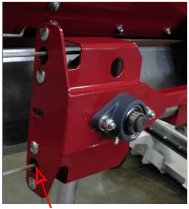
Figur 25: Avskrapere før løpehjul på wiretrekket
