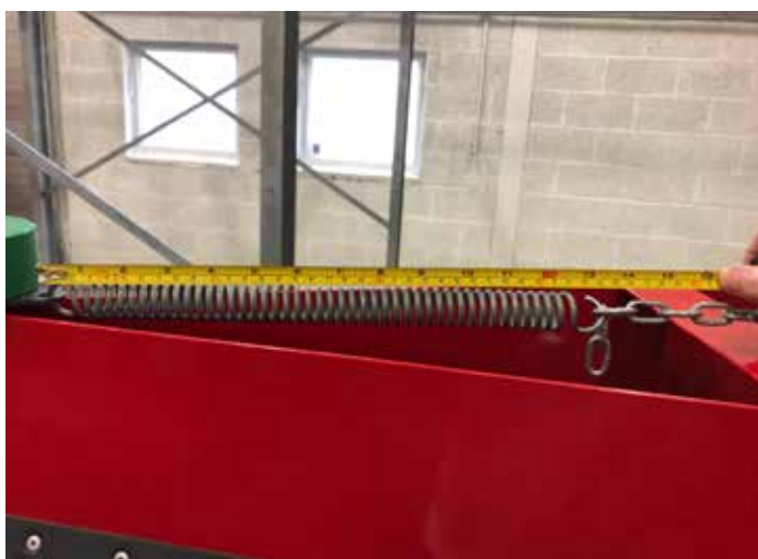
Figur 12: Måling av oppstrammet fjær. Den totale lengden måles.
