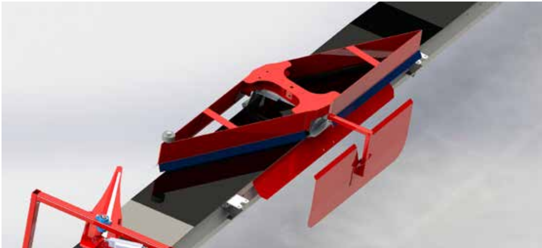
Figur 5: Bandfôringsanlegg med dobbel plog
