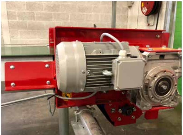
Figur 6: Drivenhet med drivmotor
