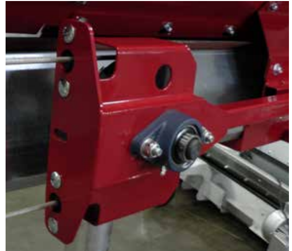
Figur 19: Wirestrammer, strammes i bakkant.
