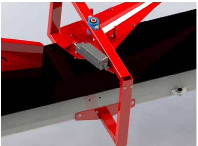
Figur 8: Sensor montert på chassis-siden ved plogvender
