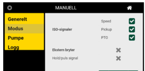
Figur 10 Skjermbilder for pumpe og modus i menyen.
