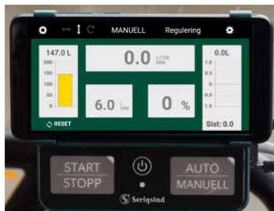
Figur 23 Markering på symbol når ekstern bryter er tilkoblet.
