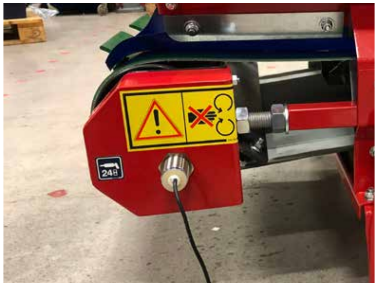
Figur 8: Sensor som rotasjonsvakt.
