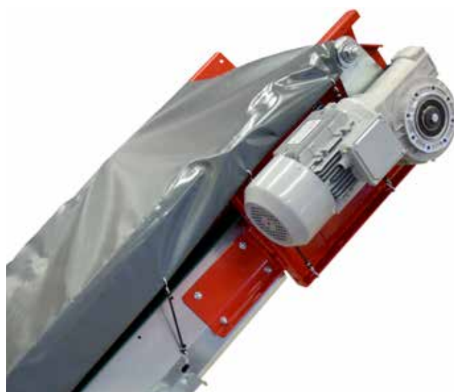
Figur 55: Plassering av strikker ved motor.
