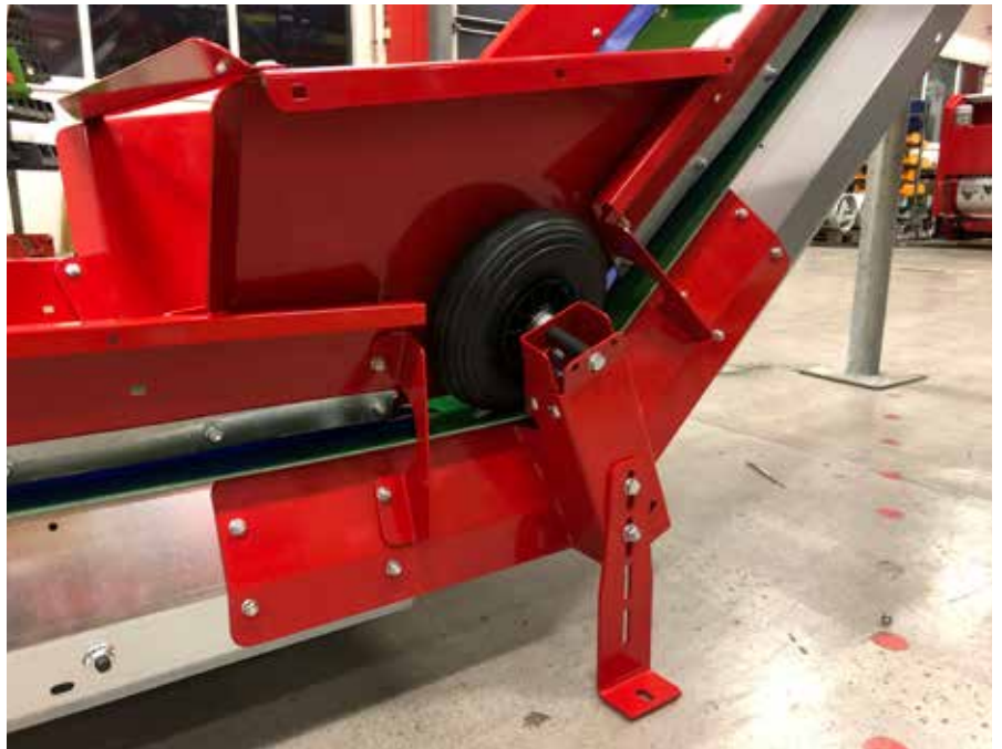
Figur 36: Ferdig montert vinkelledd.
