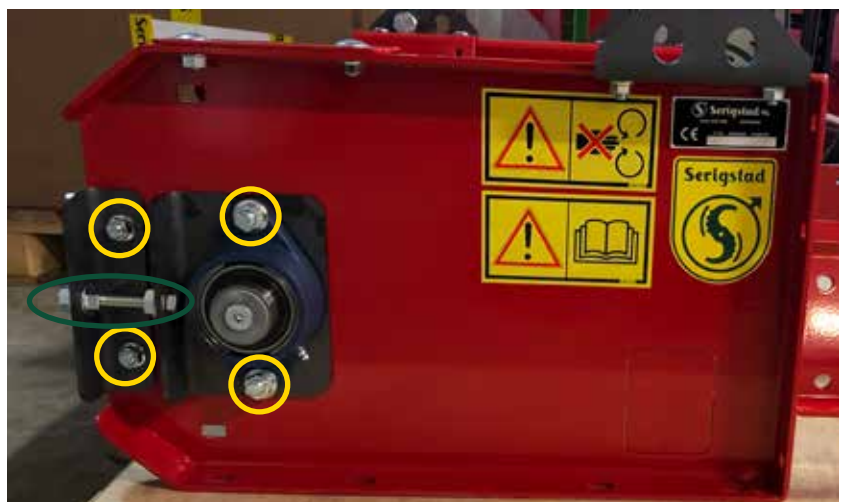
Figur 60: Løsne lagerbrakettene, gule sirkler, før justering av bandet med justeringskrue, grønn oval.
