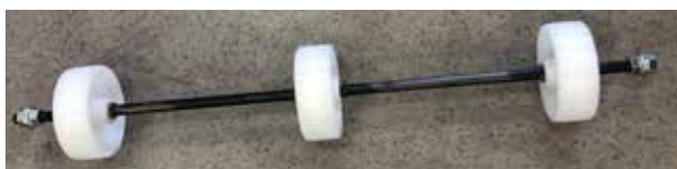
Figur 13: Aksling med støttehjul for band.
