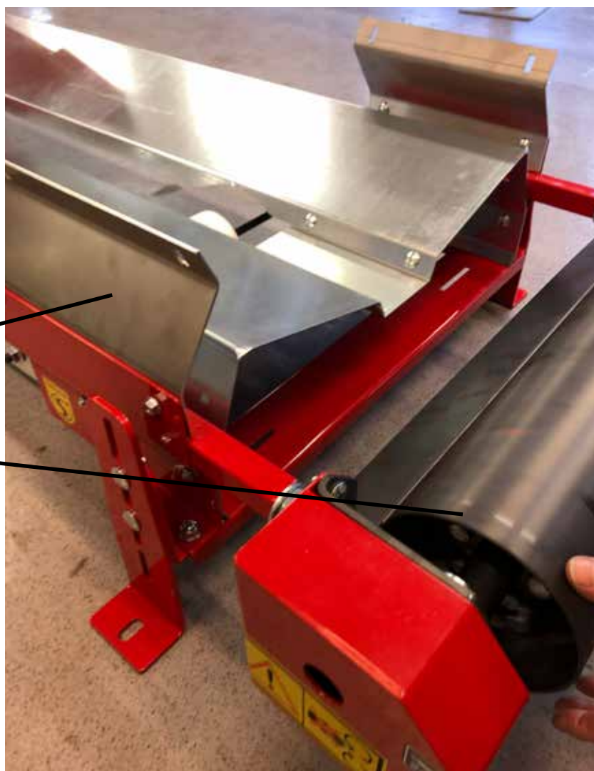
Figur 24: Strammerull og festebrakett mellom strammeenhet og toppskjerm er montert.
