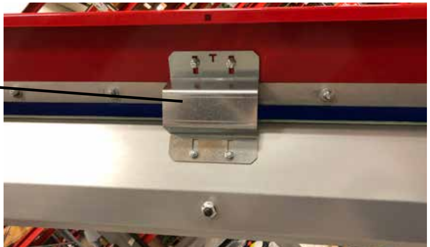
Figur 25: Støtte for toppskjerm og toppskjerm på chassis.
