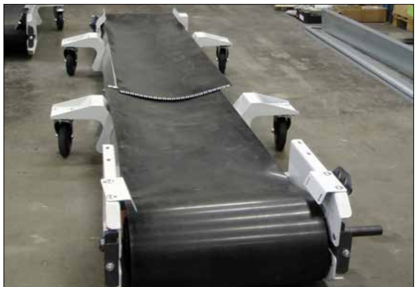
Figur 26: Band trukket på bandtransportør og forberedt med alligatorskjøt.
