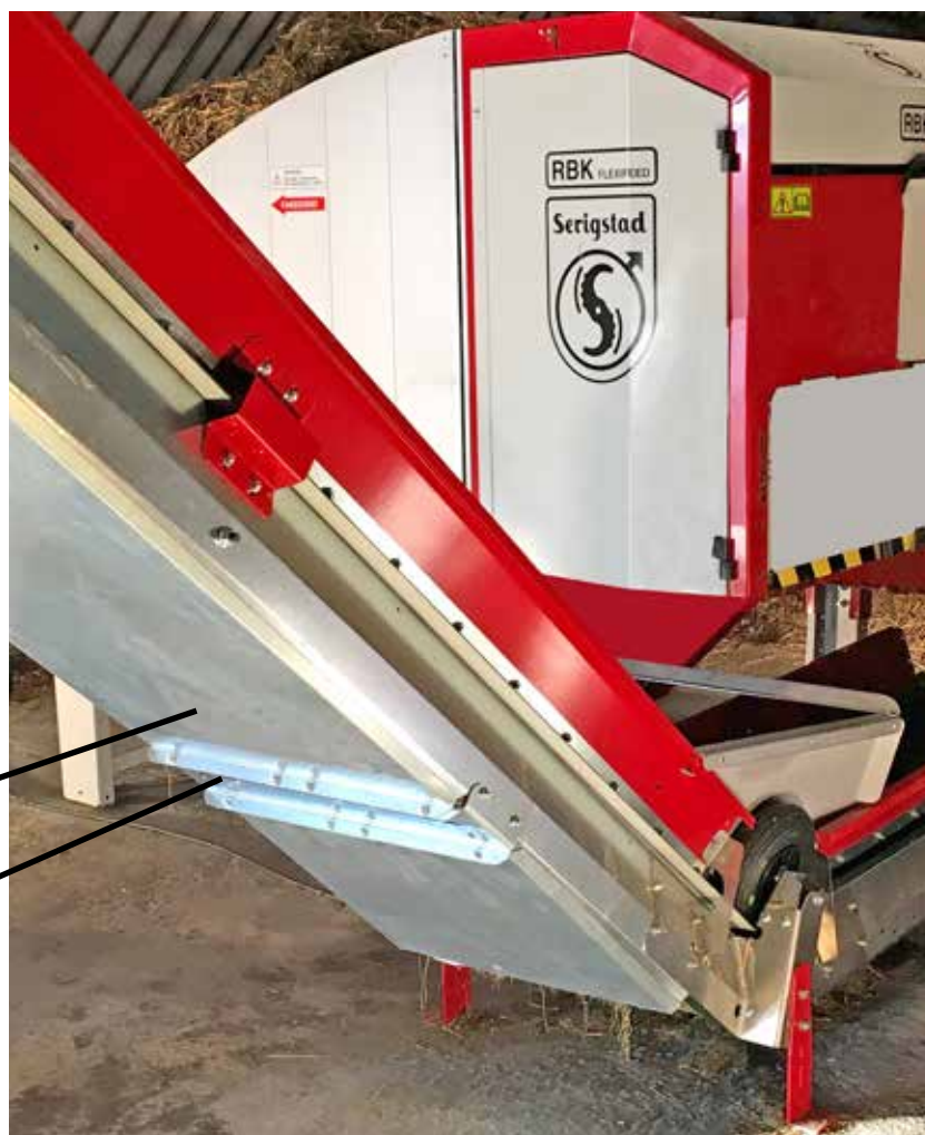
Figur 45: Underdekningsplater på vinklet bandtransportør.
