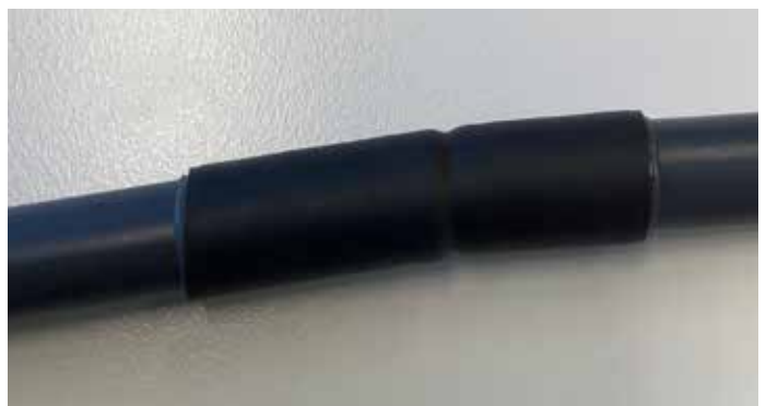
Figur 49: Stenger skjøtet med krympestrømpe.
