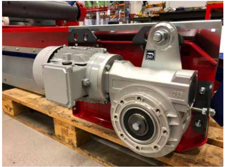
Figur 7: Motor montert på drivenheten.
