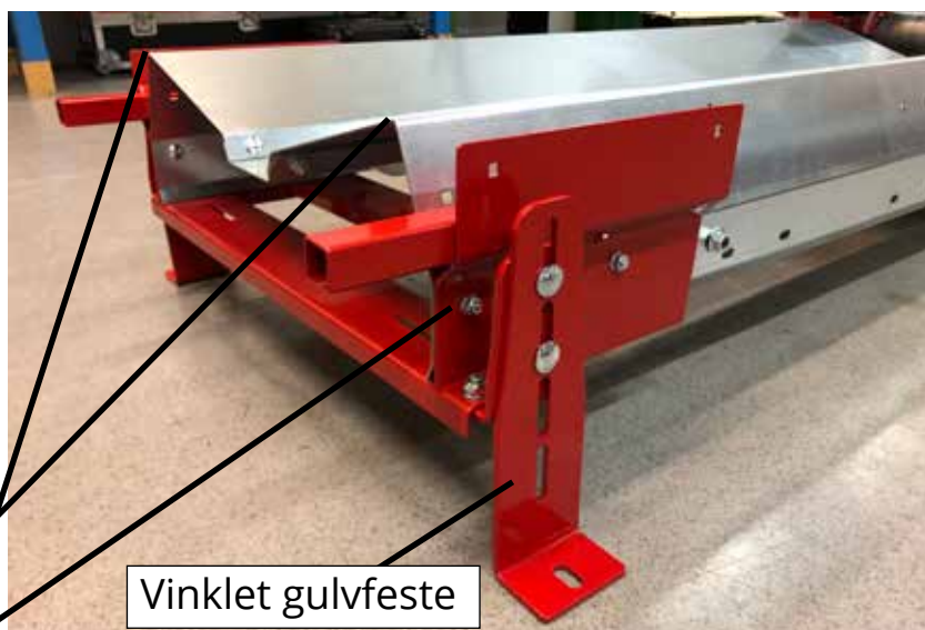
Figur 23: Chassis festet i strammeenheten og vinklet gulvfeste montert.
