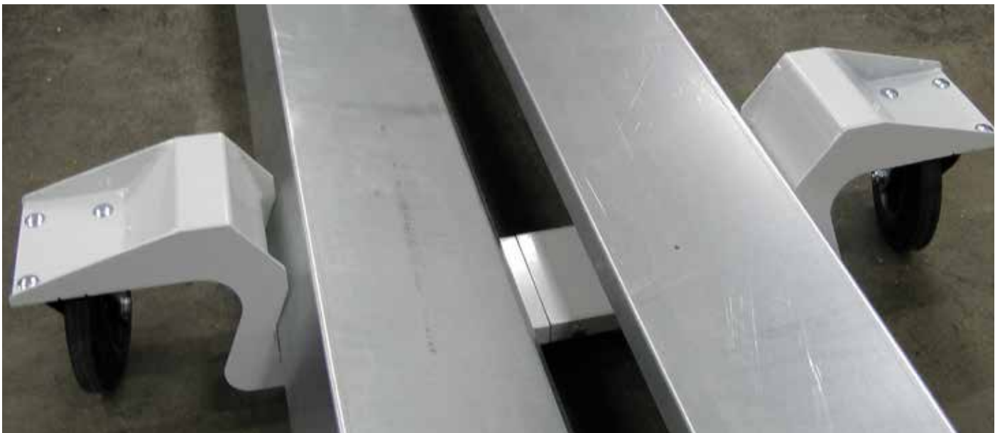
Figur 38: Hjul montert på chassis.
