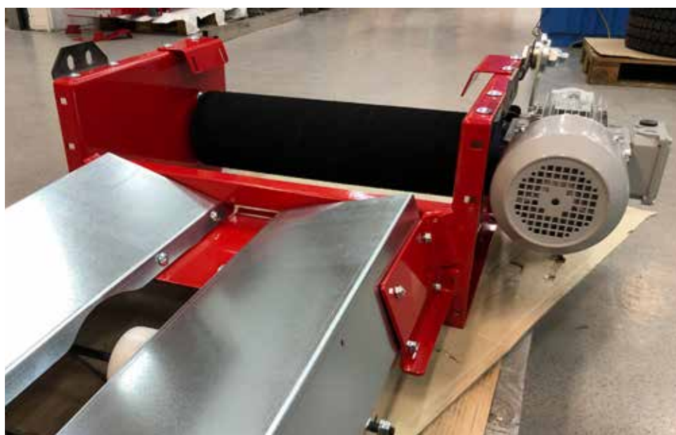
Figur 11: Chassis festet til drivenheten. Legg merke til plasseringen av boltene. Innfelt bilde: nedbøying av hjørne på chassis.
