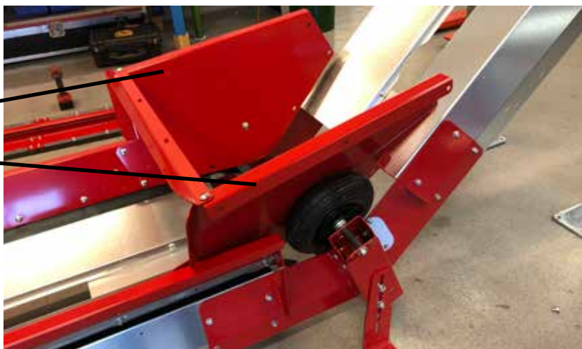
Figur 33: Hjulskjermer montert på vinkleddet.
