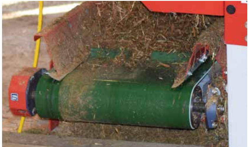
Figur 59: Band på strammerullen. Her kunne det med fordel justeres litt ut på venstre side ved deksel for strammeenheten.
