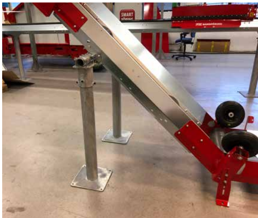
Figur 21: Beinsett montert på bandtransportør.
