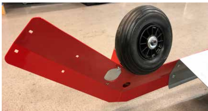
Figur 17: Vinkel monteres til chassiset på drivenheten.
