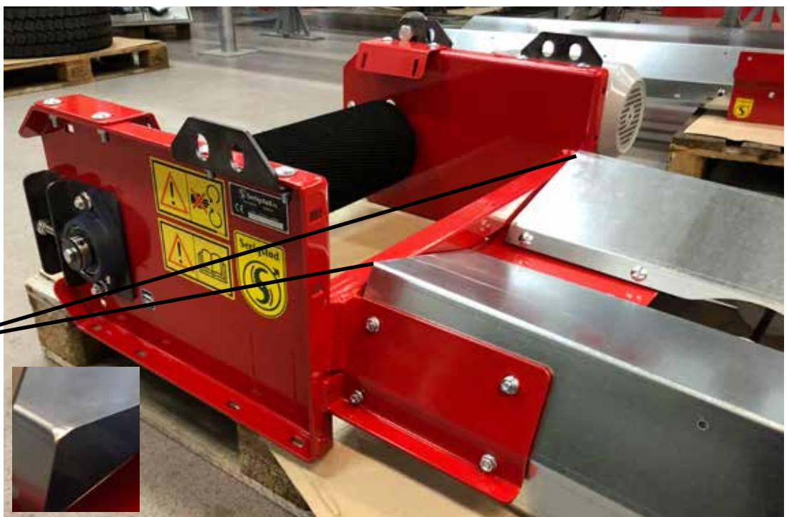
Figur 11: Chassis festet til drivenheten. Legg merke til plasseringen av boltene. Innfelt bilde: nedbøying av hjørne på chassis.
