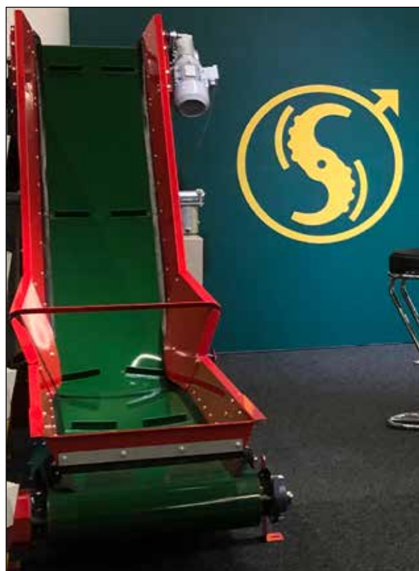
Figur 64: Bandtransportør ferdig montert med band.
