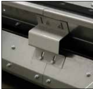
Figur 25: Støtte for toppskjerm og toppskjerm på chassis.
