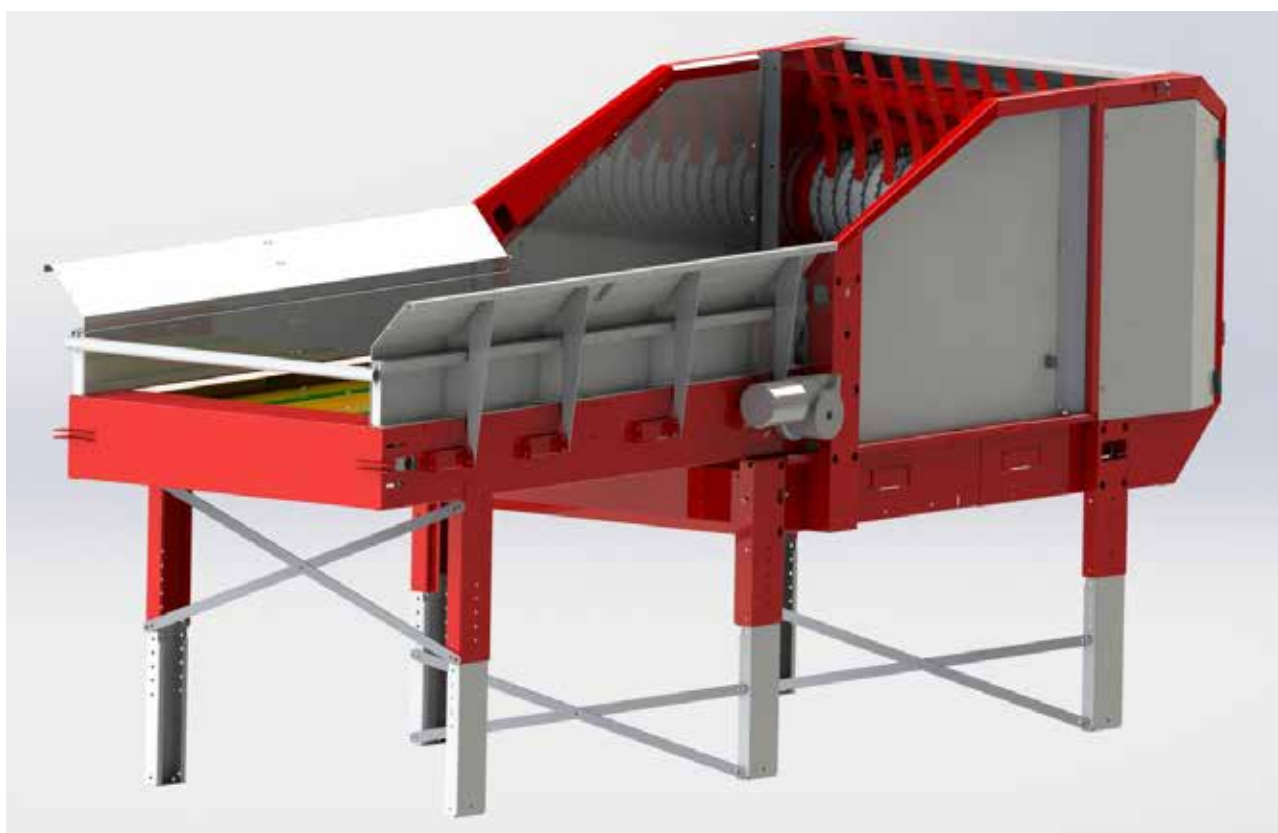
Figur 6: ExactFeeder med kort matebord. ExactFeederen har avstivingsstag nede på beinsettene og matebordet har avstivingsstag oppe på beinsettet. Dersom matebordet har flere seksjoner monteres de påfølgende avstivingsstagene som det bakre på figuren.
