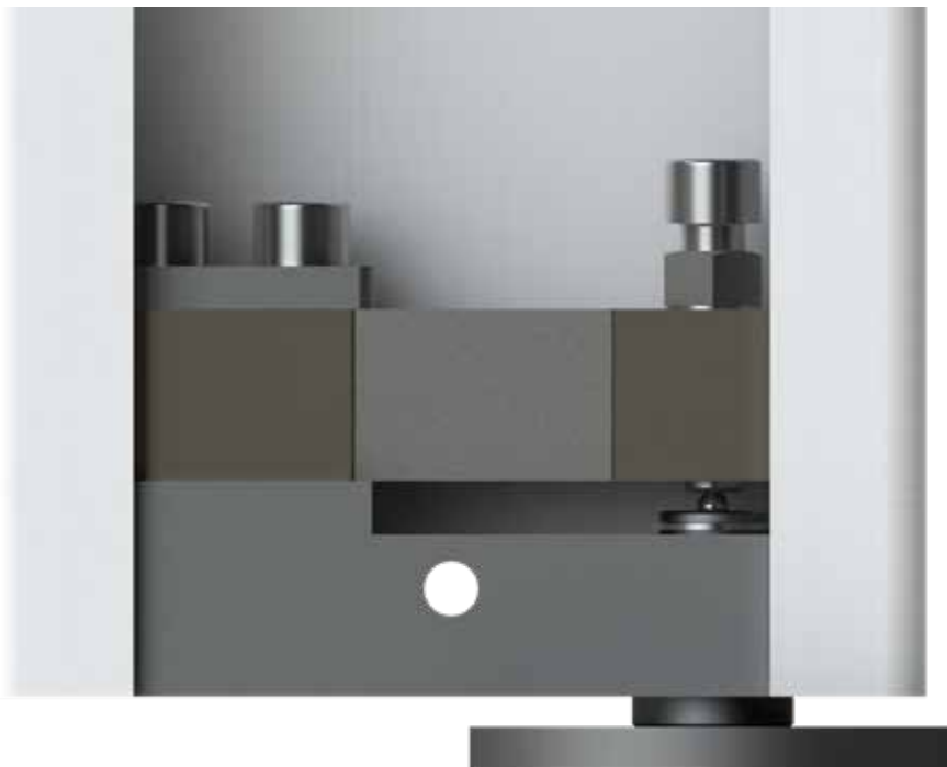
Figur: Veiecelle montert i bein.
