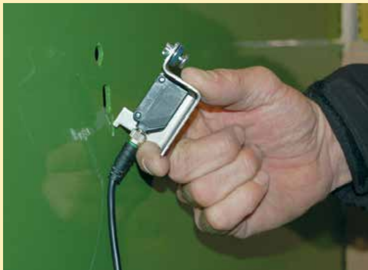
Figur 27: Fotocelle med monteringshull
