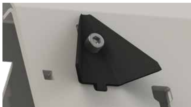
Figur 35: Kniv montert på knivtrommelen.
