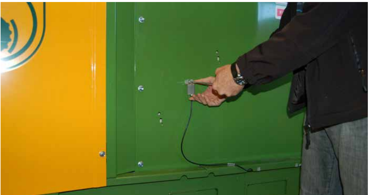
Figur 26: Fotocelle monteres i siden på ExactFeederen
