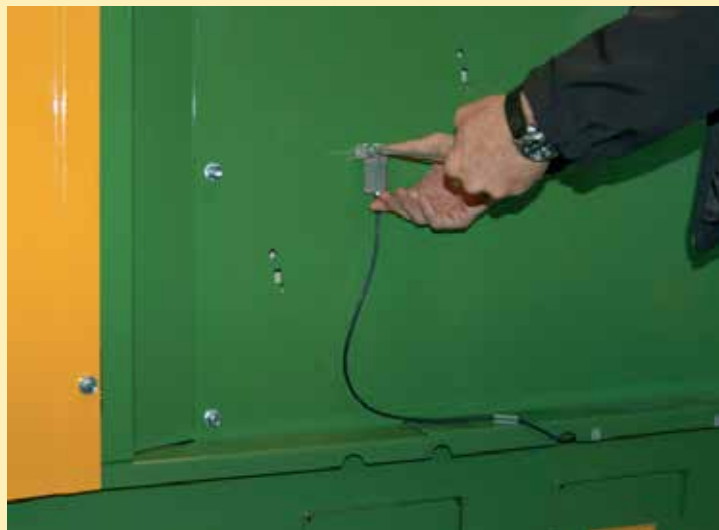
Figur 28: Fotocelle festes enkelt med et skrujern
