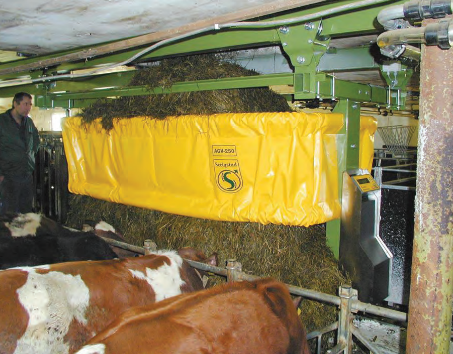
Serigstad sin automatiske, batteridrevne grovfôrvogn, AGV. Selv om produksjonen nå er lagt ned, er mange vogner fremdeles i drift i norske båsfjøs. Foto: Serigstad.
