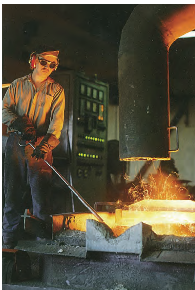
Fra støperiet. Smelting av jern i elektrisk induksjonsovn. Året er 1989. Foto: Serigstad.
