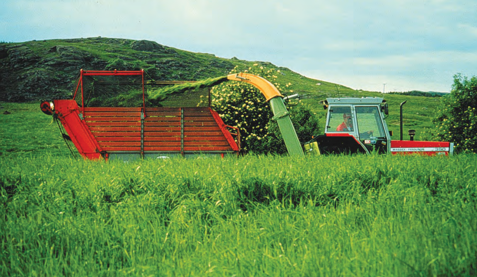
Fôrhøster fra Serigstad og avlesservogn fra Underhag (senere Kverneland) var en svært vanlig utstys-kombinasjon på Jæren og ellers i landet fra slutten av 70-tallet og langt inn på 2000-tallet. Foto: Serigstad.
