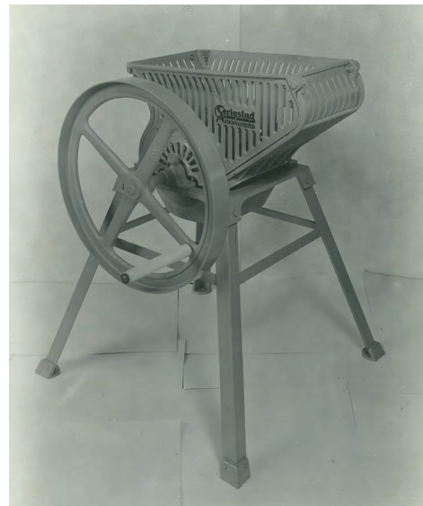
Neperasperen ble laget i mange modeller hos Serigstad opp gjennom årene. Dette er en senere modell som alternativt kunne leveres med elektrisk motor med reimdrift over svinghjulet.
