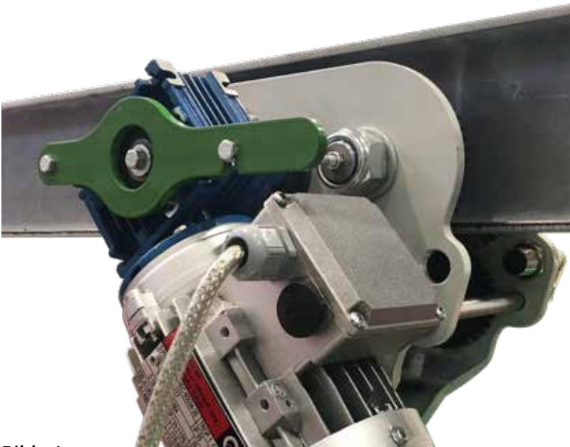
Bilde 1: Løpekatt med hendel for utløsning av motor.
