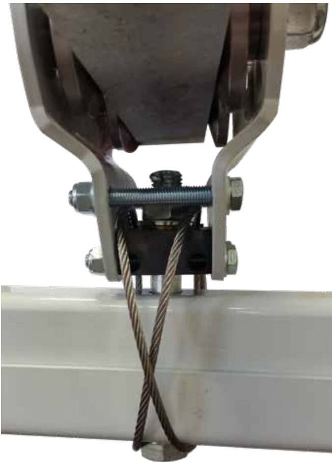
Bilde 5: Forside av travers med sikkerhetswire montert rundt løpekatt og travers.
