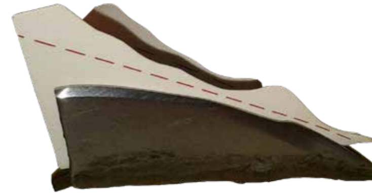
Figur 38: Utslitt kniv med knivmal. Kniven skal byttes når kniveggen er lavere enn den stiplede linjen.
