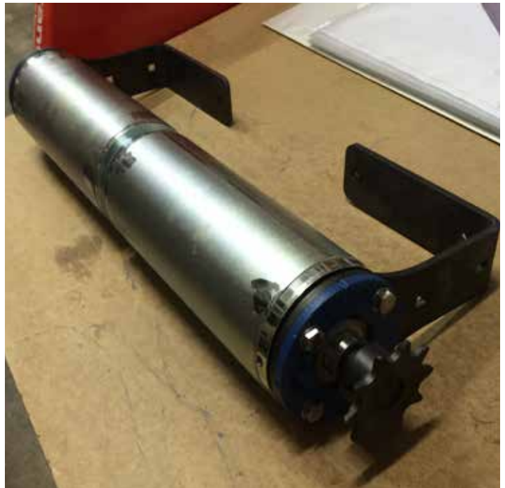
Figur 26 Drivrull demontert fra sideutmateren.
