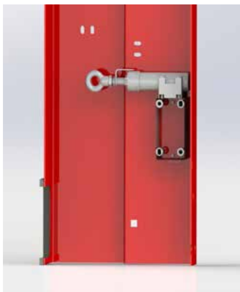
Figur 9: Tverrsnitt av portstolpe med montert nødstoppbryter sett fra innsiden av SafeGuard.
