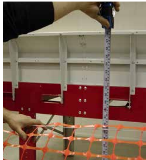
Figur 51: Test og avlesing av høyde ved aktivert nødstoppbryter.
