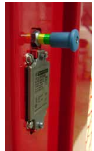
Figur 55: Pullswitch er resatt og aktivert.
