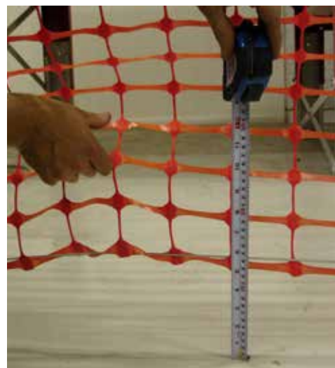
Figur 53: Test og avlesing av høyde ved aktivert nødstoppbryter.
