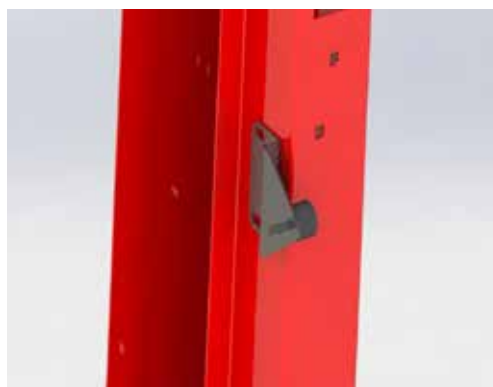
Figur 12: Portstopper montert på portstolpen sett i profil.
