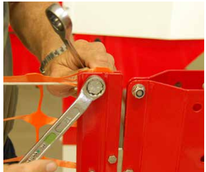
Figur 62: Strammeskruen roteres minst to omdreininger for å spole wiren rundt strammeskruen før den festes med mutteren.
