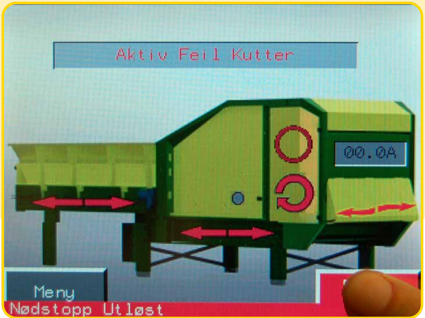
Figur 59: Skjerm bilde av styreskjermen til SafeGuard. Nødstop er utløst og må resettes.
