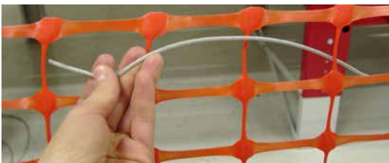
Figur 44: Wire tres inn i sikkerhetsnettet.
