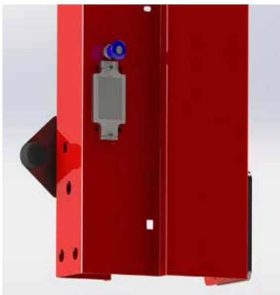
Figur 8: Nødstoppbryter montert på portstolpe
