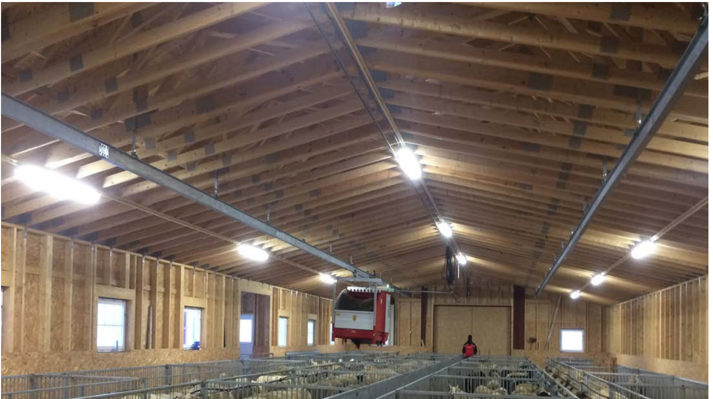
Figur 19 OneTouch Feeder i skinne med stedstilpasset oppheng.
