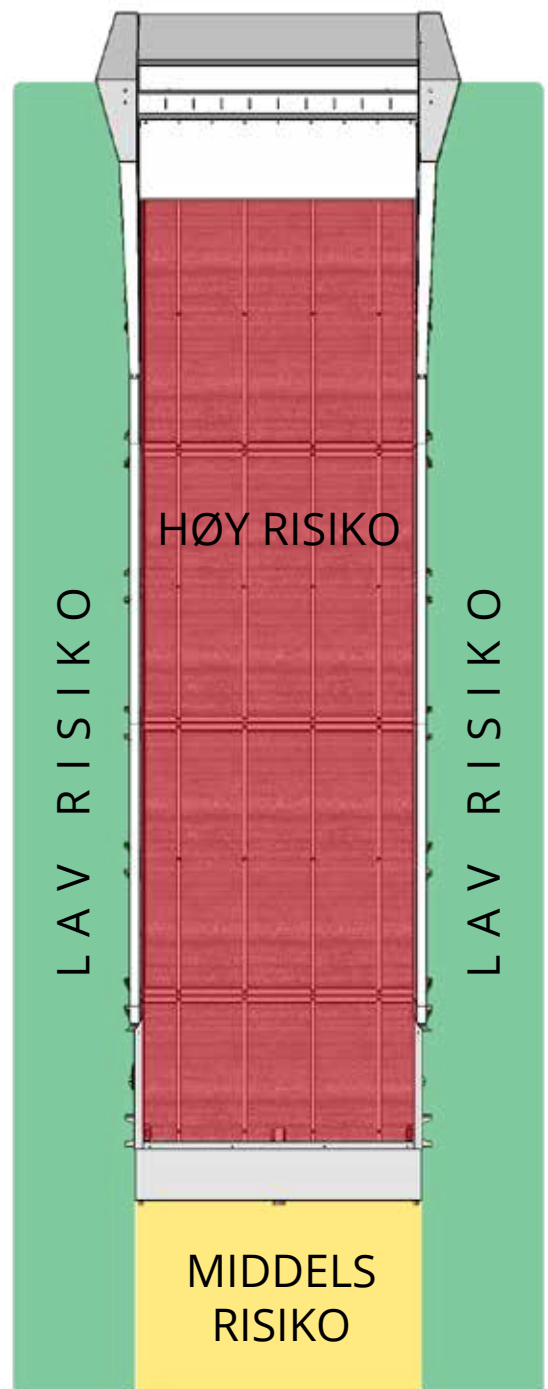
Figur 4: MaxiFeeder med faresoner.
