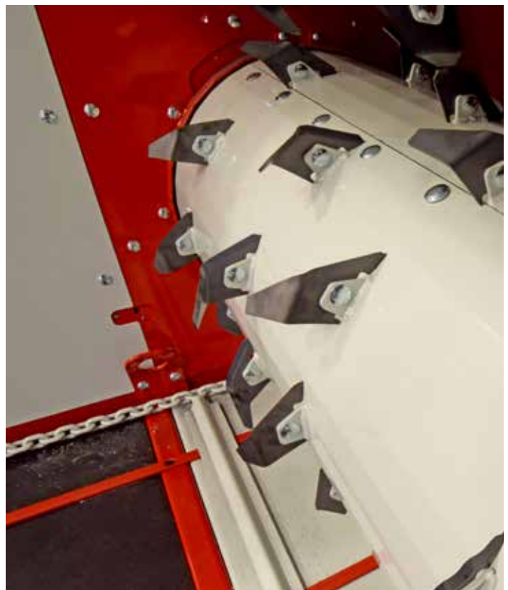
Figur 48: Kniv for tørr masse montert på knivtrommelen.
