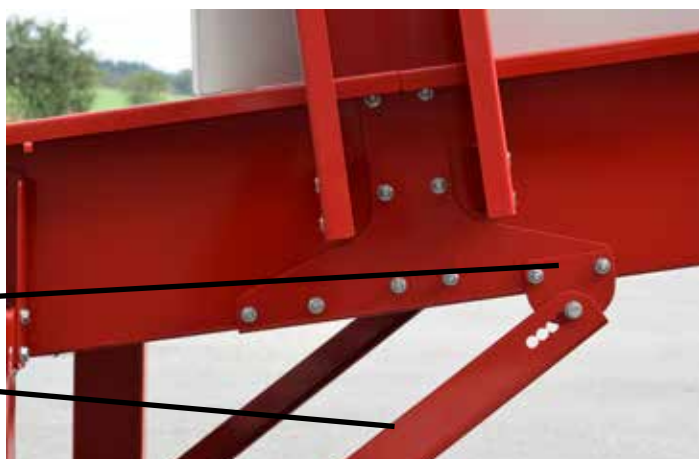
Figure 13: Avstivningsstag festet til bunnrammen med brakett.
